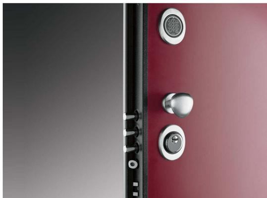
L'inserimento di un codice numerico (fino ad un massimo di 8 cifre) viene elaborato dal processore della scheda elettronica interna, e se riconosciuto valido, genera l'apertura della serratura. L'eventuale manomissione della tastiera non comporta la possibilità da parte di malintenzionati di avere accesso all'abitazione, in quanto il codice criptato è posto nella memoria elettronica della serratura.
